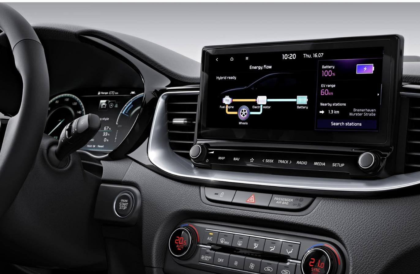
\* In bestimmten Situationen wird auch im Elektro-Modus der Verbrennungsmotor automatisch aktiviert - zum Beispiel wenn der Ladezustand der Hybridbatterie unter ein bestimmtes Niveau sinkt, der Beschleunigungsbedarf hoch ist oder der Fahrzeuginnenraum beheizt werden soll.
