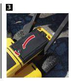
Drehen Sie zum Öffnen des Batteriefachs den Metallring und heben Sie die Batteriefachabdeckung an.
