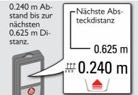
Bei einer Entfernung von weniger als 0.1 m zum nächsten Absteckpunkt gibt das Gerät einen Signalton ab. Diese Funktion kann durch Drücken der Taste Zurück / Aus been-
