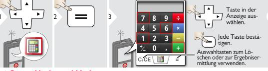
Das Messergebnis aus der Hauptzeile wird in den Rechner übernommen und kann für weitere Berechnungen herangezogen werden. Fuss/Zoll-Brüche werden in
