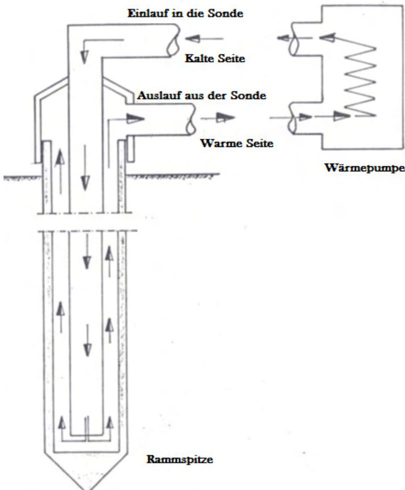
Abb.: System einer koaxialen Erdwärmehaube
