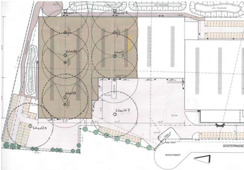
Abb.: Lageplan der 7 Sondenfelder in und außerhalb der Halle
