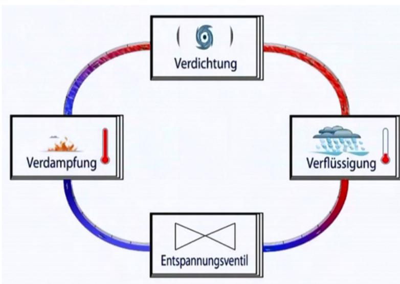
Abb.: Wirkungsprinzip der Wärmepumpe
