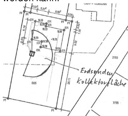
Abb.: Teilweise Einbringung der Erdsonden unter das Gebäude.
