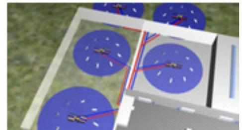
Abb.: überbaute Sondenfelder der Drehtainer – Anlage in Valluhn (376 kW)
