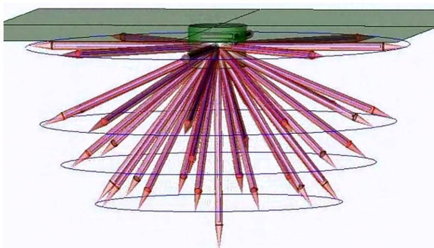
Abb.: Prinzip der radialen Sondeneinbringung
