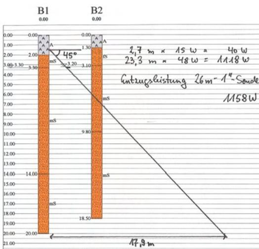
Abb.: Berechnung der Entzugsleistung
