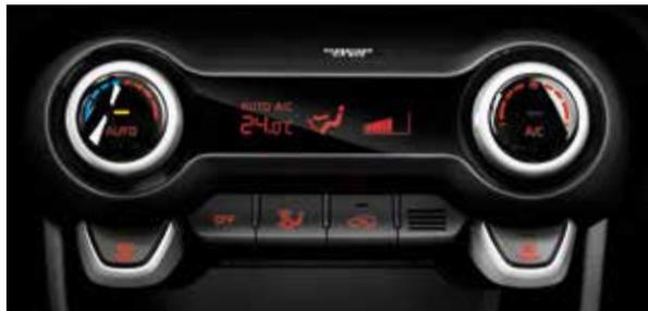
**Klimaautomatik\***. Stell einfach deine Wunschtemperatur ein – dieses System hält sie dann unabhängig von äußeren Einflüssen automatisch konstant.
