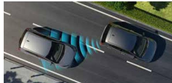
**Spurwechselassistent mit Totwinkelwarner<sup>AA</sup>.** Mithilfe von Radarsensoren erkennt das BCW-System (Blind-Spot Collision Warning) herannahende Fahrzeuge im Bereich des toten Winkels und warnt dich bei Bedarf optisch und akustisch davor, die Fahrspur zu wechseln. Solltest du es dennoch versuchen, erfolgt bei den Ausführungen mit AMT-Getriebe automatisch ein Lenk- und Bremsengriff, um eine Kollision zu vermeiden.
