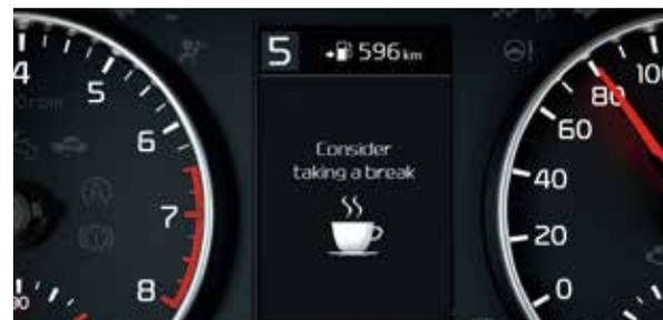
**Müdigkeitwarner<sup>AA</sup>.** Der Müdigkeitwarner (Driver Attention Warning, DAW) analysiert ständig verschiedene Fahrzeugparameter wie die Betätigung von Lenkrad und Blinker. Erkennt das System bei dir Zeichen von Erschöpfung, weist es dich durch einen Warnton und eine Anzeige in der Instrumenteneinheit darauf hin.
