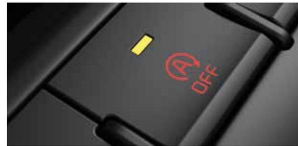
**Start-Stopp-System ISG.** Die Spritspar-Technologie ISG (Idle Stop&Go) schaltet den Motor automatisch ab, wenn das Fahrzeug zum Stehen kommt und bei den Versionen mit Schaltgetriebe kein Gang eingelegt ist.
