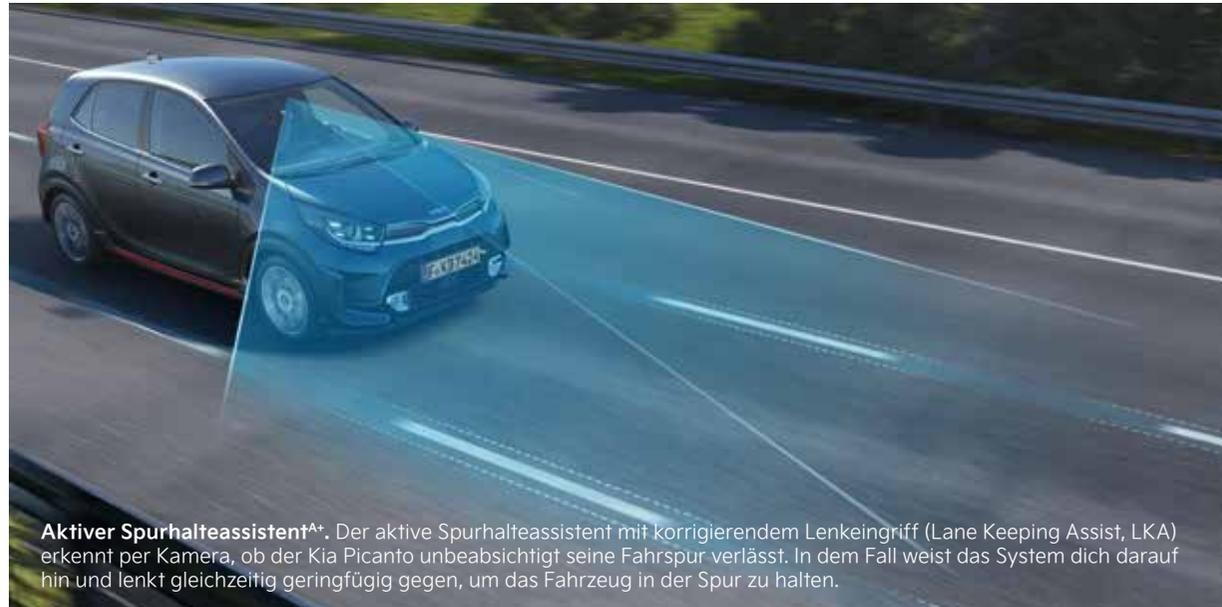
**Aktiver Spurhalteassistent<sup>AA</sup>.** Der aktive Spurhalteassistent mit korrigierendem Lenkeingriff (Lane Keeping Assist, LKA) erkennt per Kamera, ob der Kia Picanto unbeabsichtigt seine Fahrspur verlässt. In dem Fall weist das System dich darauf hin und lenkt gleichzeitig geringfügig gegen, um das Fahrzeug in der Spur zu halten.
