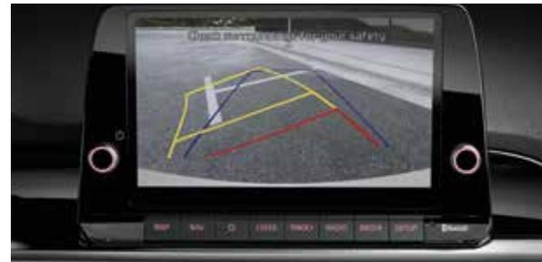
**Rückfahrkamera mit dynamischen Hilfslinien<sup>AA</sup>.** Beim Rückwärtsfahren erscheinen auf dem Touchscreen\* des Audio- oder Navigationssystems\* die Kamerabilder inklusive Hilfslinien, die dir das Manövrieren erleichtern.
