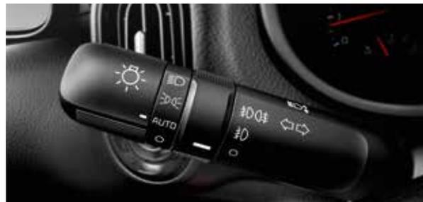
**Dämmerungssensor**. Ist die Auto-Funktion aktiviert, schaltet der Sensor bei Dunkelheit und in Tunneln die Scheinwerfer ein.
