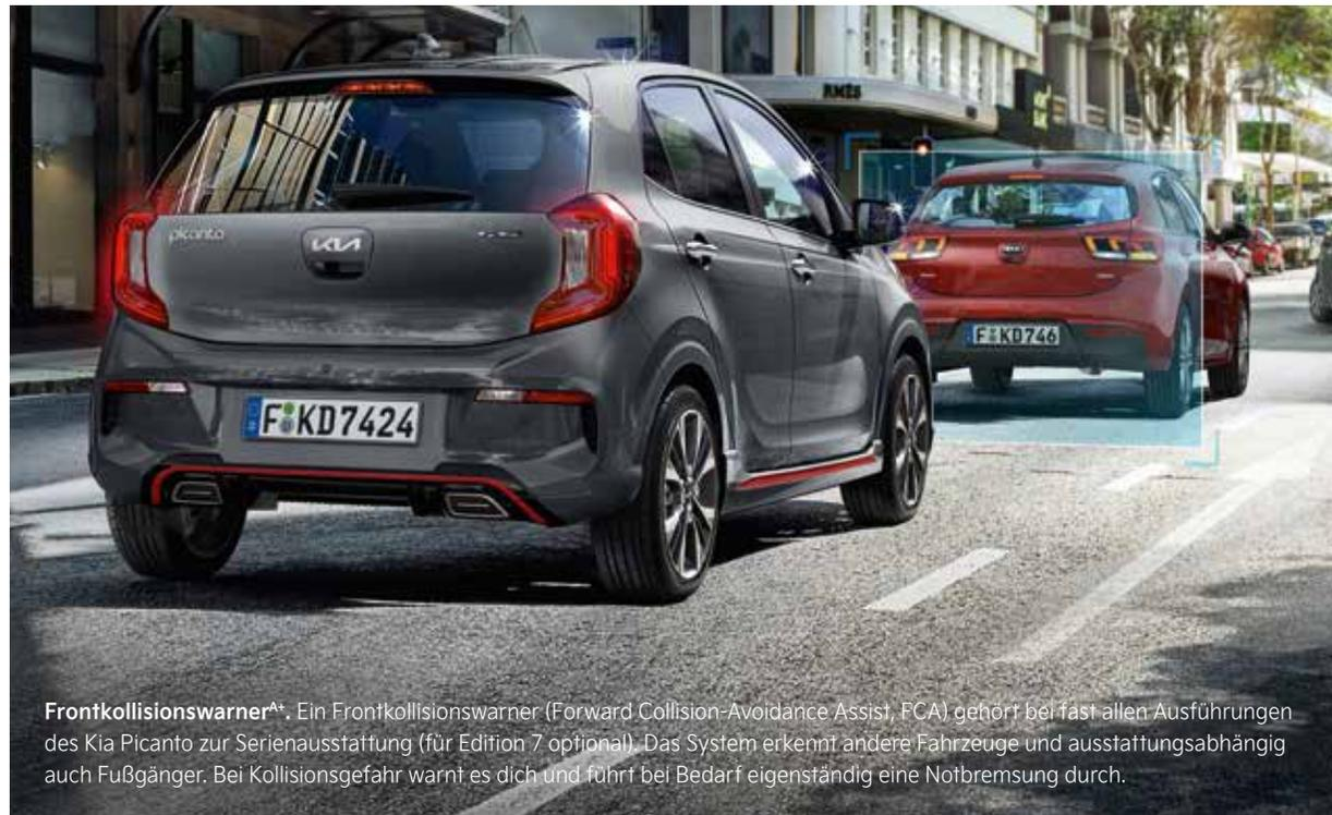
**Frontkollisionswarner<sup>AA</sup>.** Ein Frontkollisionswarner (Forward Collision-Avoidance Assist, FCA) gehört bei fast allen Ausführungen des Kia Picanto zur Serienausstattung (für Edition 7 optional). Das System erkennt andere Fahrzeuge und ausstattungsabhängig auch Fußgänger. Bei Kollisionsgefahr warnt es dich und führt bei Bedarf eigenständig eine Notbremsung durch.
