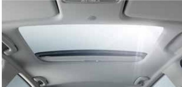
**Glasschiebedach\***. Schafft einen lichtdurchfluteten, luftigen Innenraum: das elektrische Glasschiebedach, das sich auch aufstellen lässt.
