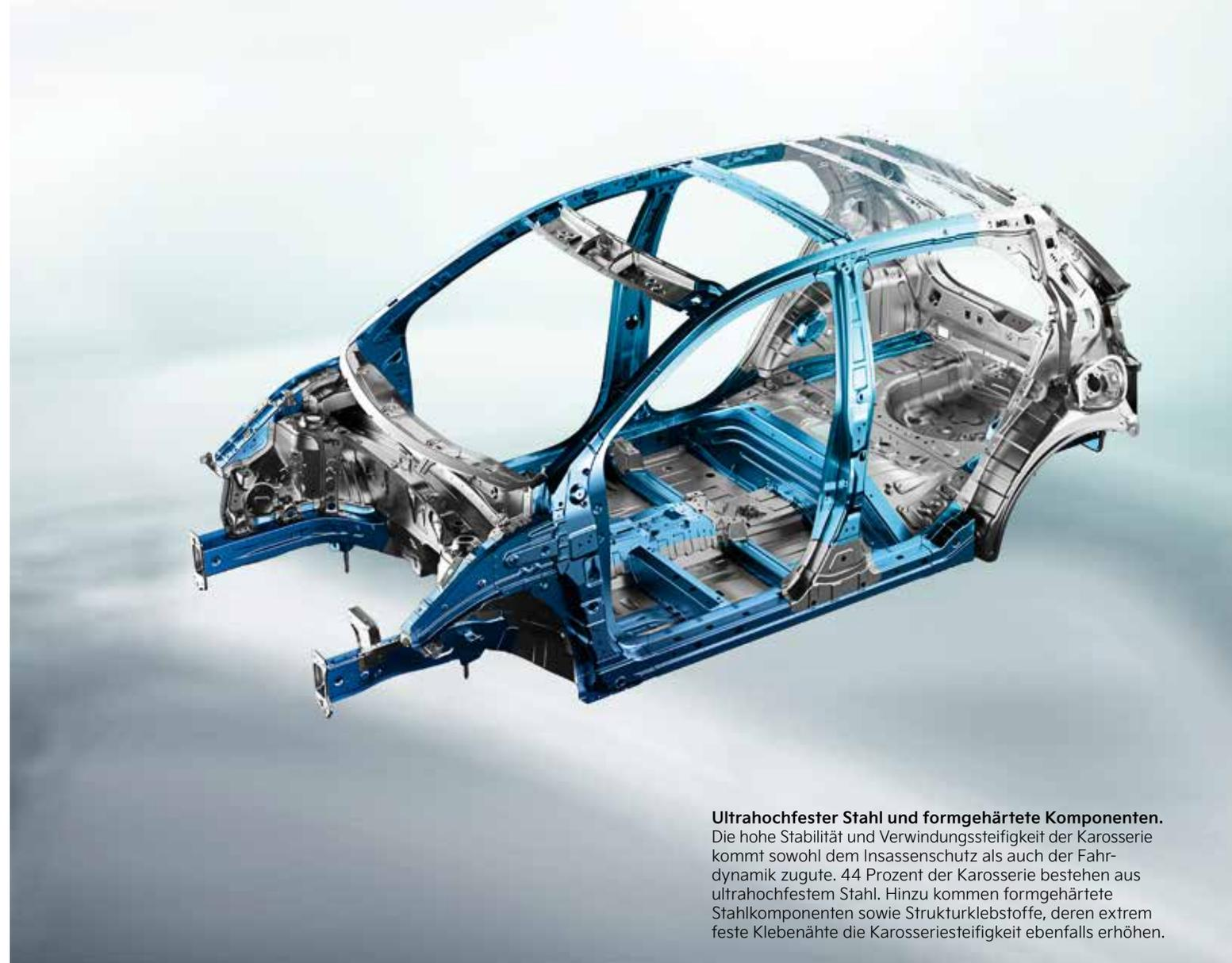
**Ultrahochfester Stahl und formgehärtete Komponenten.** Die hohe Stabilität und Verwindungssteifigkeit der Karosserie kommt sowohl dem Insassenschutz als auch der Fahrdynamik zugute. 44 Prozent der Karosserie bestehen aus ultrahochfestem Stahl. Hinzu kommen formgehärtete Stahlkomponenten sowie Strukturklebstoffe, deren extrem feste Klebenähte die Karosseriesteifigkeit ebenfalls erhöhen.
