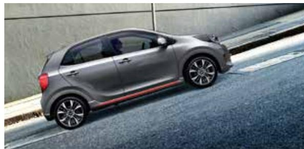
**Berganfahrhilfe (HAC).** Die Berganfahrhilfe (Hill-start Assist Control) verhindert das Zurückrollen beim Anfahren an Steigungen. Wenn du den Fuß vom Bremspedal nimmst, hält die Bremswirkung eine Zeit lang an, damit du in Ruhe anfahren kannst.
