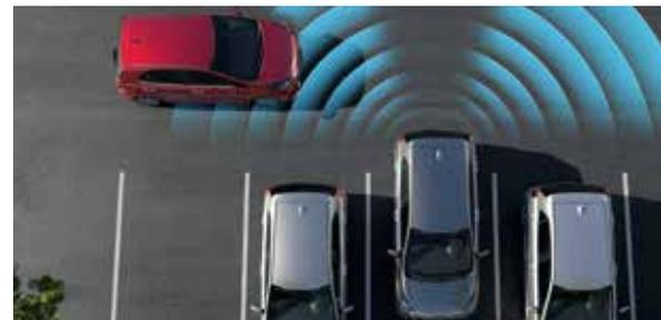
**Querverkehrwarner<sup>AA</sup>.** Beim Zurücksetzen aus Parklücken oder Einfahrten warnt dich der Querverkehrwarner (Rear Cross-Traffic Collision Warning, RCCW) durch optische und akustische Signale vor Fahrzeugen, die deinen Weg kreuzen. Bei den Ausführungen mit AMT-Getriebe erfolgt zudem automatisch ein Bremsengriff, wenn die Notbremsfunktion aktiviert ist.
