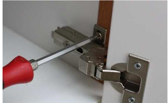
Die vorderere Einstellung ermöglicht Ihnen die Justierung nach vorne und hinten.
