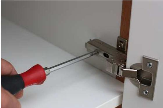
An der Montageplatte können Sie die Höheneinstellung der Front in vertikaler Richtung verstellen.
