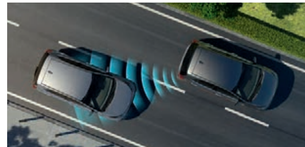
Spurwechselassistent mit Totwinkelwarner AA . Mithilfe von Radarsensoren erkennt das BCW-System (Blind-Spot Collision Warning) herannahende Fahrzeuge im Bereich des toten Winkels und warnt dich bei Bedarf optisch und akustisch davor, die Fahrspur zu wechseln. Solltest du es dennoch versuchen, erfolgt bei den Ausführungen mit AMT-Getriebe automatisch ein Lenk- und Bremsengriff, um eine Kollision zu vermeiden.
