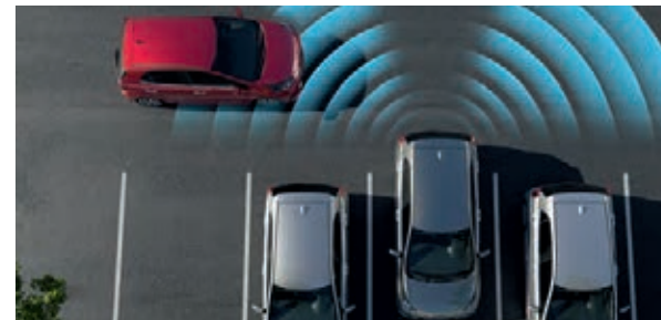
Querverkehrswarner AA . Beim Zurücksetzen aus Parklücken oder Einfahrten warnt dich der Querverkehrswarner (Rear Cross-Traffic Collision Warning, RCCW) durch optische und akustische Signale vor Fahrzeugen, die deinen Weg kreuzen. Bei den Ausführungen mit AMT-Getriebe erfolgt zudem automatisch ein Bremsengriff, wenn die Notbremsfunktion aktiviert ist.
