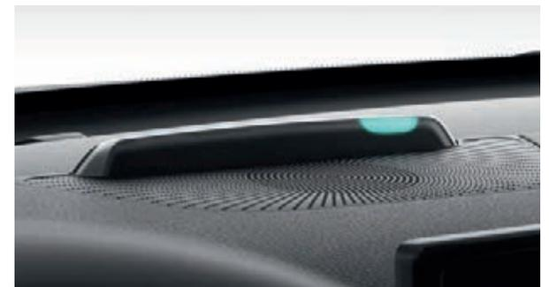
**Ladeanzeige.** Geschickt in das Lautsprechergitter in der Mitte des Armaturenbretts eingebettet, zeigen drei blaue LED-Leuchten den Ladestatus der Batterie an, wenn du deinen XCeed Plug-in Hybrid ans Stromnetz angesteckt hast. Mit der schon von Weitem sichtbaren Anzeige hast du den Ladestand jederzeit gut im Blick.
