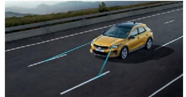
**Spurhalteassistent<sup>^</sup>.** Bleib' immer auf Kurs mit dem serienmäßigen aktiven Spurhalteassistent (Lane Keep Assist, LKA). Er behält per Kamera ständig die Fahrbahnmarkierungen im Blick. Bei einem unbeabsichtigten Verlassen der Fahrspur warnt es dich und lenkt zugleich geringfügig gegen, um das Fahrzeug in der Spur zu halten.
