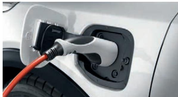
**Ladeanschluss.** Ob an einer normalen 230V-Haushaltssteckdose oder an einer öffentlichen Ladestation: Du kannst deinen Kia XCeed Plug-in Hybrid überall bequem aufladen. Schon nach ca. 2 Stunden und 45 Minuten ist er an einer öffentlichen Ladestation bereit für die nächste elektrische Tour.
