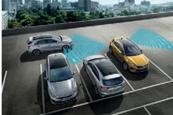
**Querkehrwarner<sup>A\*</sup>.** Dein siebter Sinn beim Rückwärtsfahren aus Parklücken oder Einfahrten. Der Querkehrwarner (Rear Cross-Traffic Collision Warning, RCCW) überwacht präzise die toten Winkel und warnt dich vor Fahrzeugen, die deinen Weg kreuzen.
