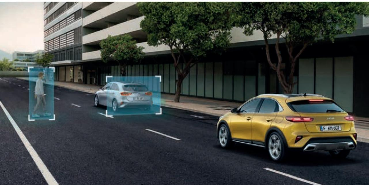
**Frontkollisionswarner<sup>^</sup>.** Per Kamera und Radarsensoren kann der Frontkollisionswarner (Forward Collision-Avoidance Assist, FCA) die Gefahr einer Kollision mit Fahrzeugen, Fußgängern, Radfahrern oder Hindernissen erkennen, dich warnen und den Kia XCeed sogar abbremsen, um einen Aufprall zu vermeiden oder dessen Folgen zu verringern.
