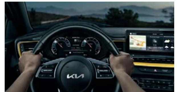
**Müdigkeitswarner<sup>^</sup>.** Langer Tag im Büro oder schon eine weite Strecke gefahren? Der Müdigkeitswarner (Driver Attention Warning, DAW) erkennt durch die Überwachung von Lenkrad, Blinker und Beschleunigungsmustern, ob deine Konzentration abbaut. Erkennt es Anzeichen von Müdigkeit, schlägt es dir durch eine akustische Warnung und ein Kaffeetassen-Symbol in der Instrumenteneinheit eine Pause vor.
