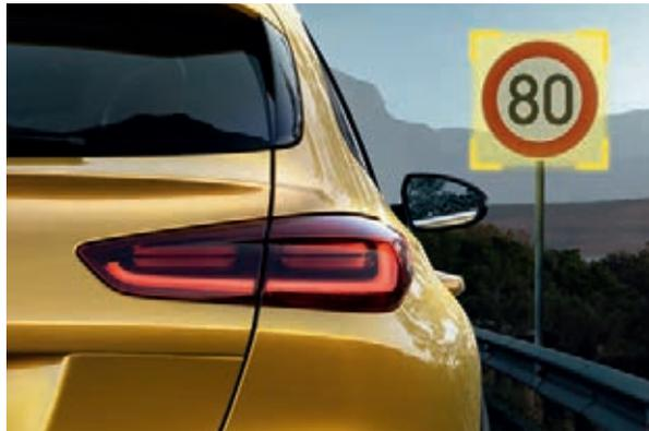
**Verkehrszeichenerkennung<sup>A\*</sup>.** Verschenke keine Gelegenheit. Die Verkehrszeichenerkennung für Geschwindigkeitsbegrenzungen (Intelligent Speed Limit Warning, ISLW) erkennt per Kamera Schilder mit Tempolimits und Überholverbote und zeigt dir diese Informationen in der Instrumenteneinheit und auf dem Bildschirm des Navigationssystems\* und in der Instrumenteneinheit an.
