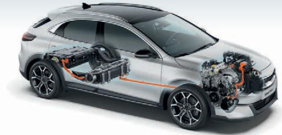
**Intelligente Technologie.** Du hast die Wahl: Mit einem Druck auf die Hybrid/Elektro-Taste (HEV/EV) in der Mittelkonsole kannst du zwischen Elektro- und Hybridbetrieb wählen. Im EV-Modus – ideal für den Stadtverkehr – nutzt der Xceed Plug-in Hybrid vorrangig rein elektrische Energie für emissionsfreies Fahren<sup>1</sup>. Im HEV-Modus werden beide Energiequellen genutzt, wobei je nach Situation entweder nur der Benzinmotor, nur der Elektromotor oder beide gleichzeitig zum Einsatz kommen.
