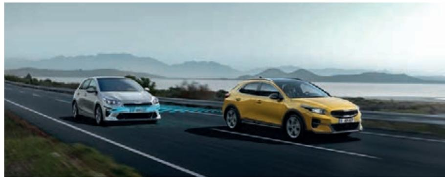
**Spurwechselassistent<sup>^</sup>.** Der Kia XCeed behält auch da den Überblick, wo du nichts siehst. Der Spurwechselassistent mit Totwinkelwarner (Blind-Spot Collision Warning, BCW) überwacht mit Radarsensoren an den Seiten und dem Heck des Kia XCeed die toten Winkel. Entdeckt der Assistent ein herannahendes Fahrzeug, warnt er dich durch optische Hinweise vor einem Fahrspurwechsel.
