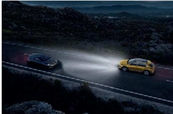
**Fernlichtassistent<sup>A\*</sup>.** Der Fernlichtassistent (High Beam Assist, HBA) erkennt bei Dunkelheit mithilfe der Frontkamera entgegenkommende und vorausfahrende Fahrzeuge. Er blendet dann automatisch ab – und wieder auf, sobald die Verkehrssituation es zulässt.
