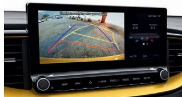
**Rückfahrkamera<sup>^</sup>.** Die Rückfahrkamera zeigt nicht nur ein scharfes Bild der rückwärtigen Umgebung auf dem Touchscreen des Navigations- und Infotainmentsystems, es projiziert dynamische Leitlinien auf das Bild und erleichtert dir so das Rangieren mit einer Wegempfehlung.
