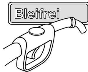
Die Benzinmotoren haben einen Tankstutzen mit kleinem Durchmesser, passend für die Bleifrei-Zapfpistolen.
