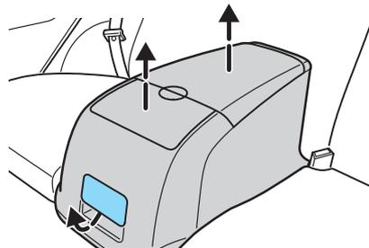
Zum Wiedereinbau des Sitzpolsters, Sitzfläche einsetzen und leicht herunterdrücken bis diese einrastet.
