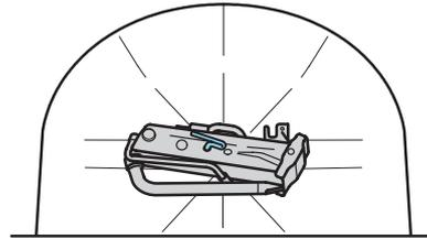
Wagenheber und Radmutternschlüssel befinden sich in der Reserveradmulde. Halteschraube entgegen dem Uhrzeigersinn herausdrehen.
