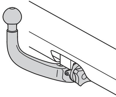
Der Kugelhals darf nur bei korrekt entriegelter Mechanik eingesetzt werden.
