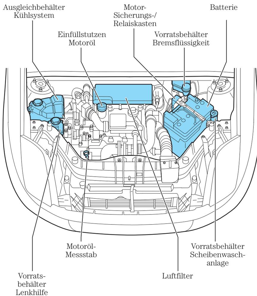
Damit Sie es leichter haben, sind die Einfüllkappen und der Motoröl-Messstab farbig markiert.
