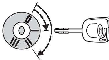
Die automatische Ladefunktion des Mobiltelefonakkus ist in der Halterung integriert und ist in Schlüsselstellung **I** oder **II** aktiv. Bei Schlüsselstellung **0** ist die Ladefunktion unterbrochen.
