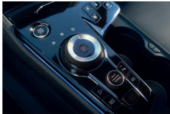
**Gangwahl-Drehschalter\***. So einfach wie nie. Der zentral und griffgünstig angeordnete Gangwahl-Drehschalter arbeitet mit Shift-by-Wire-Technologie und ermöglicht mühelose Bedienung. Ebenso wichtig für die Sicherheit: Er schaltet automatisch in den Parkgang P, solltest du das einmal vergessen. Nur in Verbindung mit Doppelkupplungsgetriebe DCT oder Automatik.
