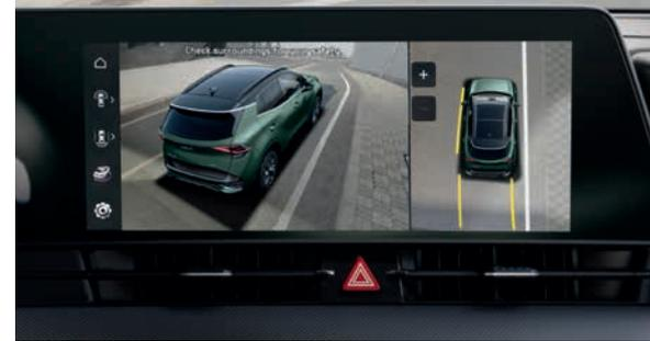
**Rundumsicht-Kamera (SVM)<sup>A\*</sup>.** Beim Manövrieren auf engstem Raum bieten mehrere Bilder der Rundumsicht-Kamera (Surround View Monitor, SVM) eine 360°-Übersicht um das Fahrzeug. Dank frei dreh- und zoombarer Außenansicht kommst du schnell und einfach auch in enge und unübersichtliche Parklücken.
