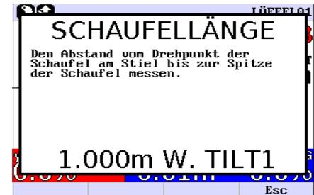
17. Messen Sie die Distanz zwischen dem Drehpunkt des Löffels und der Löffelkante.
