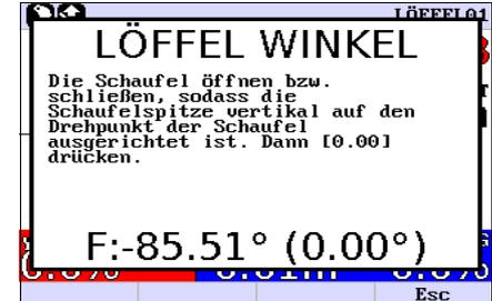
20. Stellen Sie den Baggerlöffel so auf, dass die Linie zwischen dem Drehpunkt und der Löffelkante lotrecht ist. Um sicherzustellen, dass die Linie im Lot ist, empfehlen wir eine Wasserwaage zur Hilfe zu nehmen. Bei Windstille kann auch ein Lot an den Drehpunkt gehängt werden. Dann den Löffel bewegen, bis die Kante den Faden berührt.
