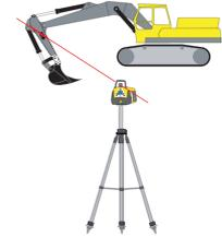
Wenn der Laserstrahl das LED-Fenster am Lasersensor trifft, beginnen die Pfeile links an der Steuerungseinheit an zu blinken und weisen in die Richtung, in der der Laserstrahl auftritt.
