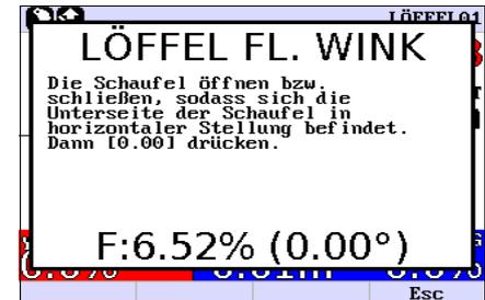
23. Bringen Sie den Baggerlöffel in eine Position, in der der Löffel verwendet werden kann um die Oberfläche zu ebenen.
