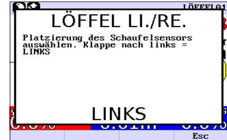
8. Wählen Sie, ob der Löffel Sensor rechts oder links angebracht wird. ◆.
