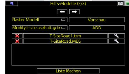
DWG/DXF-Modelle können auch als gewöhnliche Hilfsmodelle verwendet werden. Alle hinzugefügten Modelle werden in der Draufsicht angezeigt. Geländemodelle können auch im Querprofil dargestellt werden, sofern diese Option im Einstellungsdialog aktiviert wurde. Um diesen Dialog zu öffnen, die Einstellungsschaltfläche
