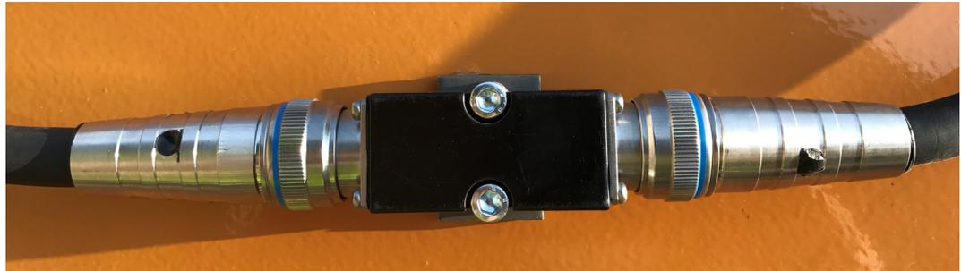
Verbindung von Neigungs- und Löffelsensor durch einen MAD1404 DE4 auf DE4 Kabeladapter.
