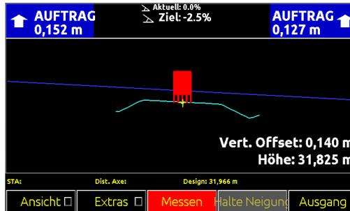
Eine parallel verschobene Oberfläche wird als blaue Linie angezeigt.
