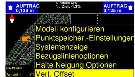
4. Die ABTRAG/AUFTRAG Werte in den oberen Ecken beziehen sich auf die verschobene Ebene. Im Querschnitt wird dies durch eine blaue Linie dargestellt.
