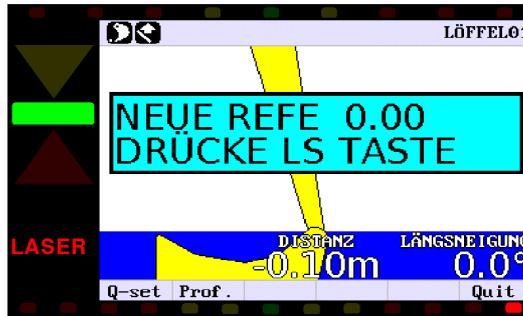
Wenn der Laserstrahl das LED-Fenster am Lasersensor trifft, beginnen die Pfeile links an der Steuerungseinheit an zu blinken und weisen in die Richtung, in der der Laserstrahl auftritt.
