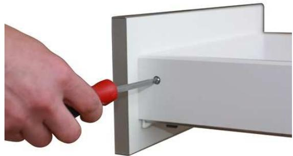
*"jetzt kann die Front 3-Dimensional nach links-rechts oben und unten ausgerichtet werden. Sind Sie mit dem Ergebnis zufrieden, die Schrauben wieder festziehen".*
