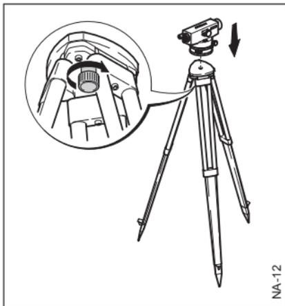
1. Nivellier auf den Stativkopf aufsetzen. Zentralanzugschraube im Stativ anziehen.
