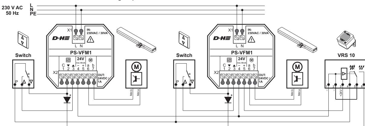
\* Wenn Sie mehrere PS-VFM1 an einen VRS 10 Regensensor anschließen, müssen jeweils Dioden wie oben beschrieben installiert werden. / If linking multiple PS-VFM1 modules to single VRS 10 rain sensor, ensure diodes are installed as detailed above.
