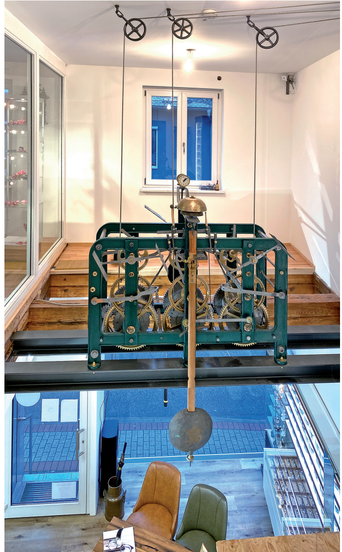
Turmuhrwerk von Vortmann ca. 1890 Freischwinger fast geräuschlos
