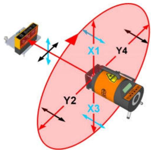
**Lichtfläche in der Y- und X-Achse** automatisch mit dem Fixier-Empfänger FE-61 und den Lasern RL-87L, PL-95L oder UL-89 über den Lotstrahl fixieren.
