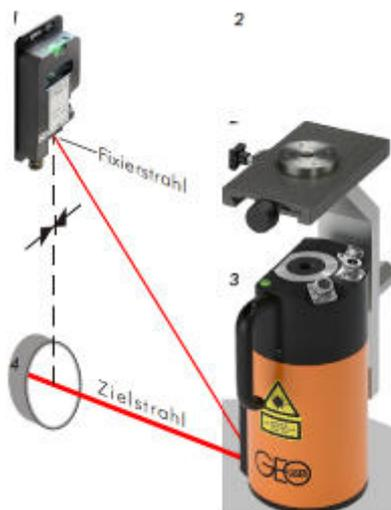
**Vollautomatischer Kegelbau-Laser KB-80L, horizontal**
