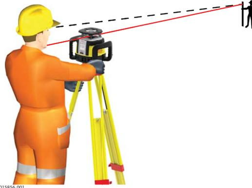
3. Drehen Sie den Rugby geringfügig, bis die Ausrichtmarken zum zweiten Kontrollpunkt ausgerichtet sind.
