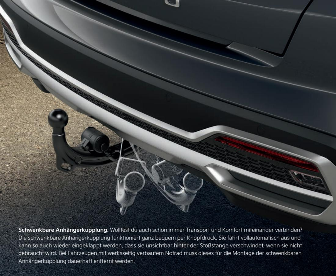
**Schwenkbare Anhängerkupplung.** Wolltest du auch schon immer Transport und Komfort miteinander verbinden? Die schwenkbare Anhängerkupplung funktioniert ganz bequem per Knopfdruck. Sie fährt vollautomatisch aus und kann so auch wieder eingeklappt werden, dass sie unsichtbar hinter der Stoßstange verschwindet, wenn sie nicht gebraucht wird. Bei Fahrzeugen mit werksseitig verbautem Notrad muss dieses für die Montage der schwenkbaren Anhängerkupplung dauerhaft entfernt werden.
