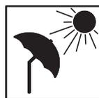
Das Instrument vor direkter Sonneneinstrahlung schützen, um eine allgemeine Erwärmung zu vermeiden. Außerdem wird darauf hingewiesen, keine Messungen bei starkem Hitzeblitz und vorhandenem Luftturbulenzen durchzuführen. Die besten Bedingungen sind früh am Morgen oder bei bedecktem Himmel.
