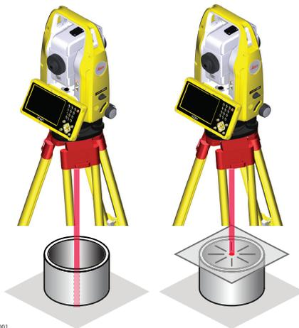
Unter gewissen Umständen ist der Laserpunkt nicht sichtbar, zum Beispiel auf Rohren. In diesem Fall kann durch Auflegen einer durchsichtigen Platte der Laserpunkt sichtbar gemacht und somit leicht auf die Mitte des Rohres zentriert werden.
