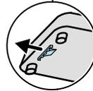
3. Beim Hochklappen des Sitzpolsters wird gleichzeitig der gesamte Sitz nach hinten geschoben. Sitz hochklappen bis zum Einrasten.
