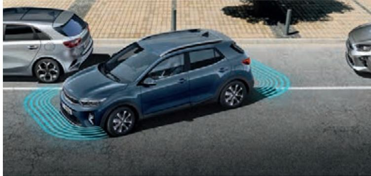
**Parkensensoren<sup>A\*</sup> vorn und hinten.** Die Parkensensoren (Parking Distance Warning, PDW) lotsen dich locker in die kleinsten Lücken. Das System nutzt dazu Ultraschallsensoren an den Stoßfängern, um dich vor Hindernissen zu warnen. Die Signaltöne können ein- oder ausgeschaltet werden.
