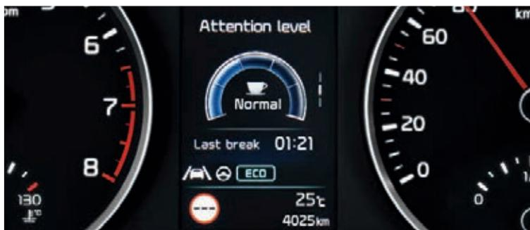
**Müdigkeitswarner<sup>A\*</sup>.** Langer Tag im Büro oder schon eine weite Strecke gefahren? Der Müdigkeitswarner (Driver Attention Warning, DAW) erkennt durch die Überwachung von Lenkrad, Blinker und Beschleunigungsmustern, ob deine Konzentration abbaut. Erkennt es Anzeichen von Müdigkeit, schlägt es dir durch eine akustische Warnung und ein Kaffeetassen-Symbol in der Instrumenteneinheit eine Pause vor.
