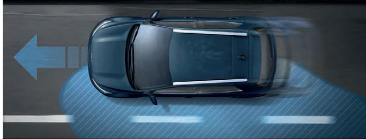
**Gegenlenkunterstützung.** Behalte auch in Extremsituationen die Kontrolle. In Zusammenarbeit mit der elektrischen Servolenkung sorgt die Gegenlenkunterstützung (Vehicle Stability Management, VSM) dafür, dass dein Stonic etwa bei Lastwechselsituationen stabil und sicher in der Spur bleibt.
