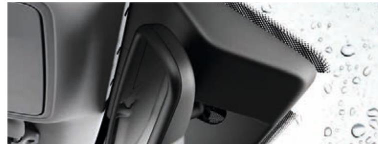
**Regensensor\*.** Registriert der Sensor Regentropfen auf der Frontscheibe, werden die Scheibenwischer entsprechend der Regenintensität aktiviert. Es kann so einfach sein.
