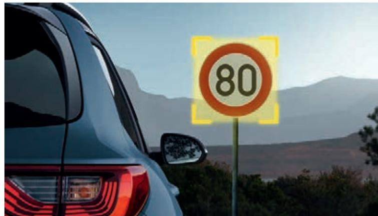
**Verkehrszeichenerkennung<sup>A\*</sup>.** Nie wieder ein Schild übersehen. Die Verkehrszeichenerkennung für Geschwindigkeitsbegrenzungen (Intelligent Speed Limit Warning, ISLW) erkennt per Kamera Schilder mit Tempolimits und Überholverbote und zeigt dir diese Informationen in der Instrumenteneinheit und auf dem Bildschirm des Navigationssystems\* und in der Instrumenteneinheit an.
