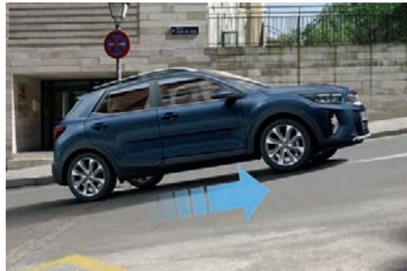
**Berganfahrhilfe.** Nie mehr hektisch am Berg zwischen den Pedalen tanzen: Die Berganfahrhilfe (Hill-start Assist Control, HAC) verzögert das Zurückrollen des Fahrzeugs beim Anfahren an Steigungen. Wenn du den Fuß vom Bremspedal nimmst, hält die Bremswirkung zwei Sekunden an, damit du in Ruhe anfahren kannst.
