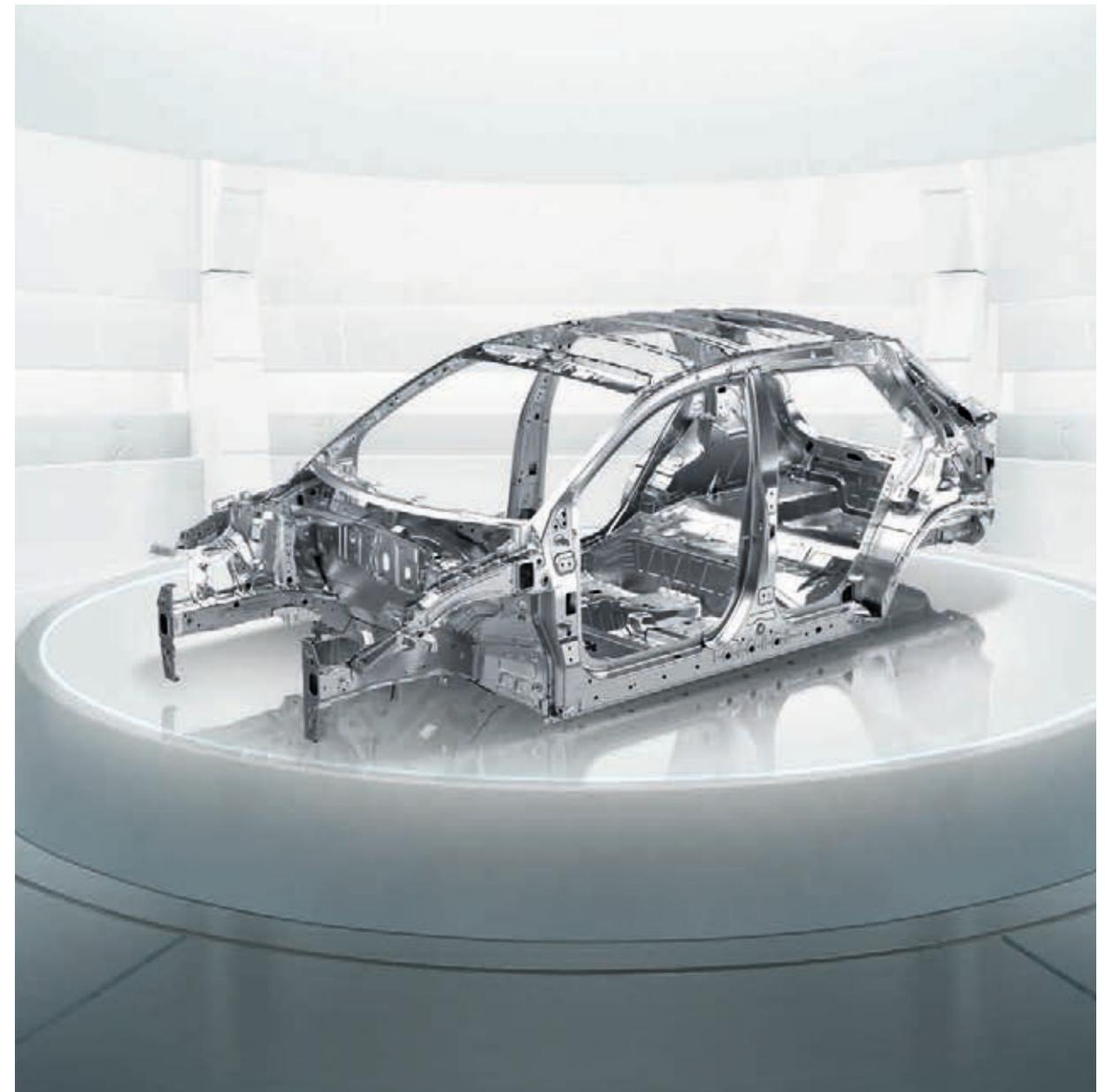
**Ultrahochfester Stahl für höchste Sicherheit und extreme Stabilität.** Die Karosserie deines Kia Stonic besteht nur aus einem intelligenten Materialmix für höchsten Insassenschutz. Der zu einem großen Teil verwendete ultrahochfeste Stahl (Advanced High Strength Steel, AHSS) sorgt mit seiner hohen Zugfestigkeit für eine phänomenale Steifigkeit der Fahrgastzelle. Damit sind nicht nur deine Mitfahrenden und du optimal geschützt, es sorgt zudem für eine verbesserte Fahrdynamik.
