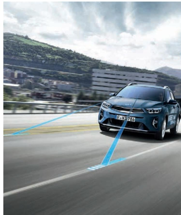
**Spurhalteassistent<sup>A\*</sup>.** Bleib' immer auf Kurs mit dem serienmäßigen aktiven Spurhalteassistent (Lane Keep Assist, LKA). Er behält per Kamera ständig die Fahrbahnmarkierungen im Blick. Bei einem unbeabsichtigten Verlassen der Fahrspur warnt es dich und lenkt zugleich geringfügig gegen, um das Fahrzeug in der Spur zu halten.
