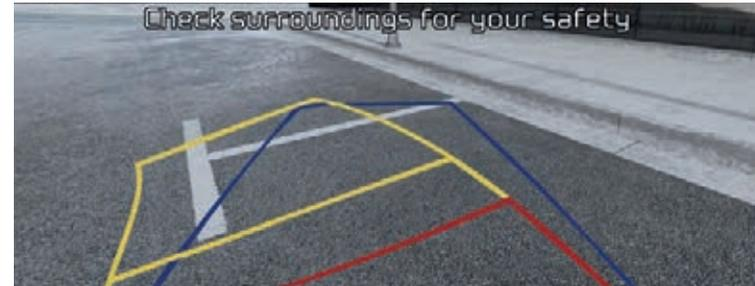
**Rückfahrkamera<sup>+</sup> mit dynamischen Hilfslinien.** Die Rückfahrkamera projiziert dynamische Leitlinien auf den 20,2-cm-Bildschirm im Armaturenbrett und erleichtert dir so das Rangieren mit einer Wegempfehlung.
