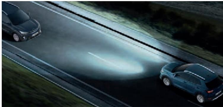
**Fernlichtassistent<sup>A\*</sup>.** Mach' die Nacht zum Tag. Der Fernlichtassistent (High Beam Assist, HBA) erkennt bei Dunkelheit mithilfe der Frontkamera entgegenkommende und vorausfahrende Fahrzeuge. Er blendet dann automatisch ab – und wieder auf, sobald die Verkehrssituation es zulässt.
