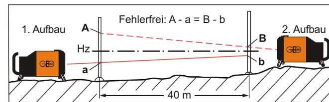
Der Kanalbau-Laser ist vom Hersteller genauestens justiert, dennoch können Stöße und starke Erschütterungen zu einer Dejustierung führen. Der Laser sollte daher in festen Abständen wie folgt überprüft werden:
