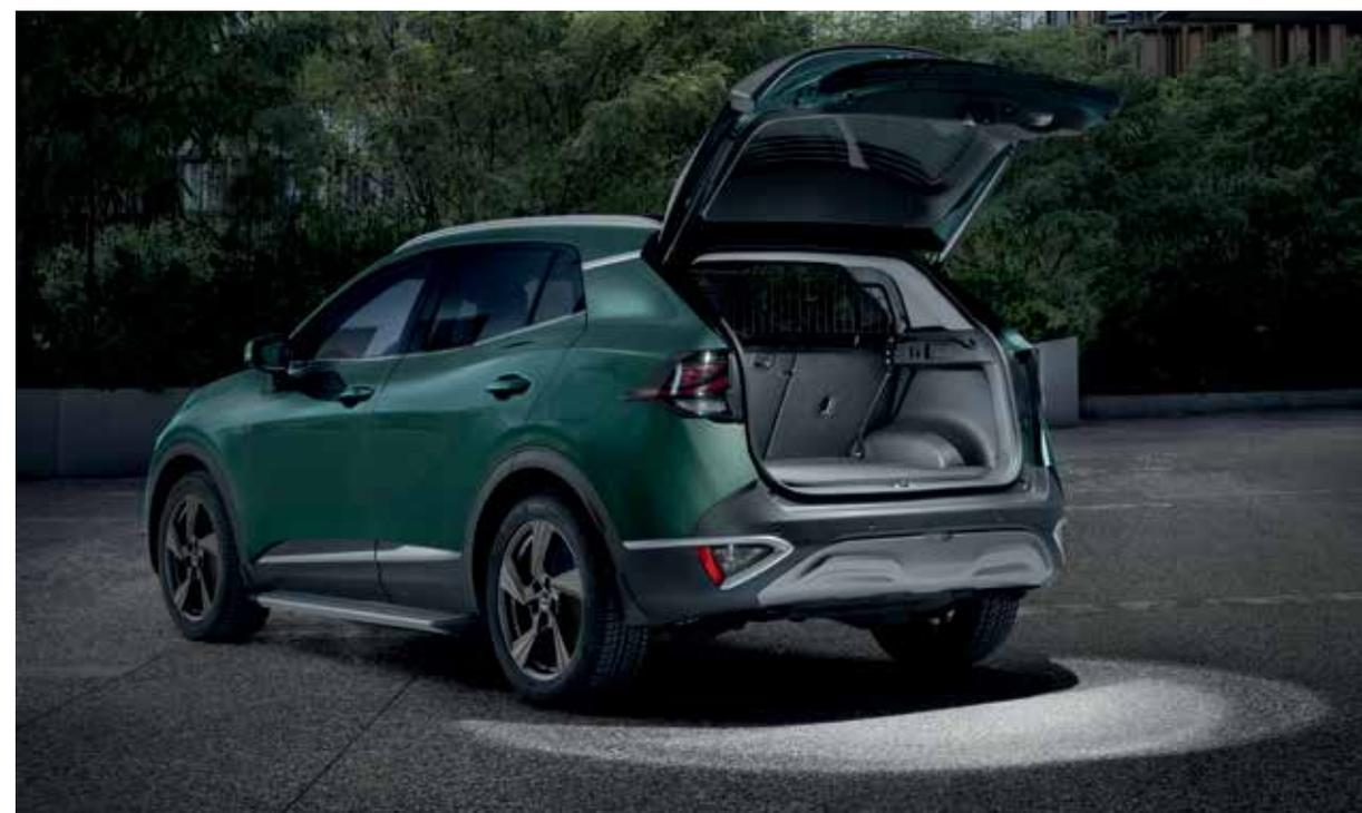
**LED Kofferraum- und Heckklappenbeleuchtung.** Nie wieder sollst du etwas in der Dunkelheit in deinem Kofferraum suchen müssen oder im Dunklen tappen. Die LEDs leuchten, sobald du den Kofferraum öffnest und bieten dir perfekte Sicht im Heckbereich deines Kia Sportage.
