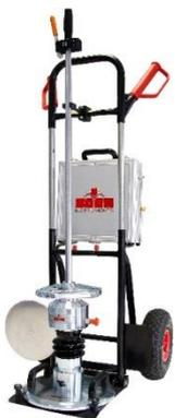
Abbildung 8: Transportwagen mit Koffer und Magnetstandfuß
