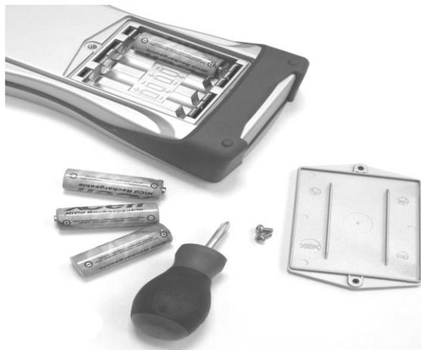
Abbildung 2: ZFG 3.0 mit geöffnetem Batteriefach
