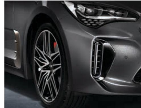
**Frontstoßfänger mit Air Curtain** Die Front des Kia Stinger ist nicht nur eindrucksvoll, sondern auch äußerst funktional gestaltet. So sorgen die seitlichen Lufteinlässe im Stoßfänger (Air Curtain) zusammen mit den Kiemen an den vorderen Kotflügeln (Air Breather) für einen ruhigeren Luftstrom an den Vorderrädern, kühlen die Bremsen und tragen bei höheren Geschwindigkeiten zur Fahrstabilität bei.
