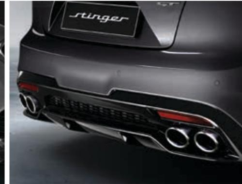
**Heckstoßfänger mit Diffusor** Der in die Unterseite des Stoßfängers integrierte Diffusor bündelt den Luftstrom am Heck und beugt Luftverwirbelungen vor. Er ist optisch zugleich eine Referenz an die Diffusoren von Rennwagen, die dazu dienen, Turbulenzen durch den unter dem Fahrzeug entstehenden Unterdruck zu vermeiden.
