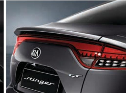
**Heckklappe mit Spoiler-Effekt** Die nach oben geschwungene, scharfe Kante der Heckklappe hat den Effekt eines Heckspoilers, der bei höheren Geschwindigkeiten den Luftstrom optimiert und für mehr Fahrstabilität sorgt – und der Silhouette des Kia Stinger zugleich einen markanten Abschluss gibt.
