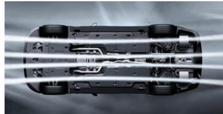
**Unterbodenverkleidungen** Während die aerodynamische Qualität der Front, des Profils und des Hecks auf ersten Blick zu erkennen sind, befinden sich weitere wichtige Elemente zur Reduzierung des Luftwiderstands im Verborgenen: die robusten, im Windkanal ausgefeilten Unterbodenverkleidungen unter dem Motorraum, unter beiden Seiten des Kabinenbodens und unter den hinteren Radaufhängungen.
