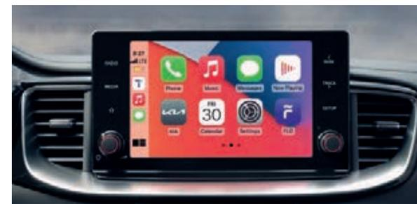
**Audiosystem mit 20,2-cm-Touchscreen\*.** Der Touchscreen des Infotainmentsystems mit Smartphone-Schnittstelle (Android Auto™, Apple CarPlay™) und digitalem Radioempfang (DAB+) zeigt unter anderem die Songtitel an und überträgt die Bilder der Rückfahrkamera<sup>A\*</sup> (Serie in Vision, optional für Edition 7).
