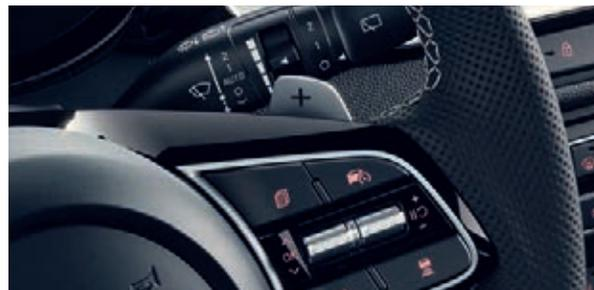
**Schaltwippen am Lenkrad<sup>+</sup>.** Das Doppelkupplungsgetriebe lässt sich bei den Ausführungen über die Schaltwippen auch manuell betätigen (ausstattungsabhängig). Das ermöglicht eine besonders sportliche Fahrweise, da du die Schaltpunkte selbst bestimmen und beide Hände am Lenkrad lassen kannst.
