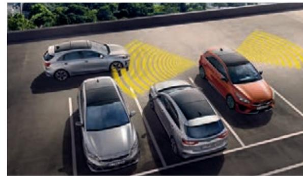
**Querverkehrwarner hinten inklusive Notbremsfunktion<sup>+</sup>.** Beim Zurücksetzen aus Einfahrten oder quer zur Fahrbahn liegenden Parklücken überwacht der Querverkehrwarner (Rear CrossTraffic CollisionAvoidance Assist, RCCA) die toten Winkel. Falls ein Fahrzeug den Weg deines Kia kreuzt, warnt dich das System akustisch und optisch. Wenn die Notbremsfunktion aktiviert ist, erfolgt außerdem automatisch ein Bremsengriff.
