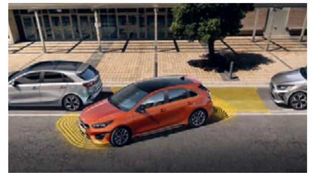
**Intelligentes Parksystem<sup>+</sup>.** Damit wird das Parken zu einer sehr entspannten Angelegenheit: Das intelligente Parksystem (Parking Assist-Perpendicular Reverse, PA-PDR) steuert deinen Kia mithilfe von Front-, Seiten- und Hecksensoren in parallel oder quer zur Fahrbahn liegende Parklücken und übernimmt in Parallelrichtung auch das Ausparken. Du musst nur noch Gas geben, bremsen und schalten.
