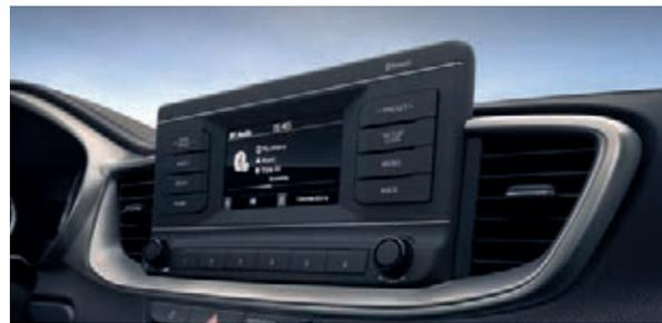
**Audiosystem.** Die Einstiegsversion Edition 7 verfügt serienmäßig über ein Radio mit 12,7-cm-Display (5 Zoll) und digitalem Radioempfang (DAB+), sechs Lautsprecher, USB-Schnittstelle und eine Bluetooth® Freisprecheinrichtung samt Musik-Streaming.
