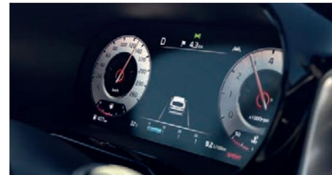
**Digitales Cockpit.** Das Kombiinstrument mit 31,2-cm-Bildschirm (12,3 Zoll) zeigt im Fahrbetrieb Tachometer und Drehzahlmesser als Rundinstrumente an und dazwischen ein Multifunktions-Display für Bordcomputer-, Navigations- und Assistenzsystem-Informationen. Schaltest du in den Sport-Modus, präsentieren sich die Grafiken der Rundinstrumente in einem geschärften Design.
