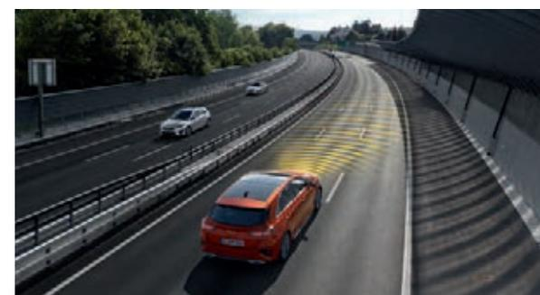
**Navigationsbasierte Geschwindigkeitsregelanlage<sup>A\*</sup>.** Dieses System, kurz NSCC (Navigation-based Smart Cruise Control), wird zusammen mit dem Autobahnassistenten eingesetzt. Auf Basis von Navigationsdaten kann es vor einer Kurve die Geschwindigkeit frühzeitig anpassen und sie anschließend wieder auf das voreingestellte Niveau erhöhen, sofern die Bedingungen es zulassen.
