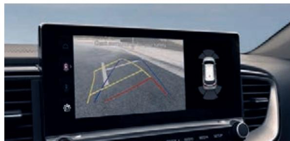
**Rückfahrkamera<sup>A\*</sup>.** Wenn der Rückwärtsgang eingelegt wird, erscheinen auf dem Multimediabildschirm die Bilder der Rückfahrkamera (optional für Edition 7, Serie in Vision). Aufgrund der erweiterten Funktionalität kannst du nun zwischen verschiedenen Ansichten mit dynamischen Hilfslinien wählen, die das Manövrieren erleichtern. Zudem lässt sich die Kamera jetzt auch beim Vorwärtsfahren aktivieren.
