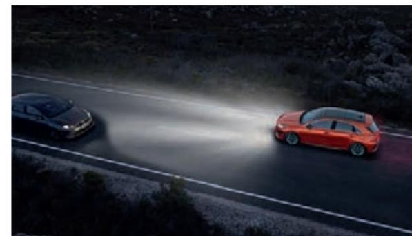
**Fernlichtassistent<sup>A</sup>.** Der serienmäßige Fernlichtassistent (High Beam Assist, HBA) erkennt bei Dunkelheit mithilfe der Frontkamera entgegenkommende und vorausfahrende Fahrzeuge. Das System blendet dann automatisch ab – und wieder auf, sobald die Verkehrssituation es zulässt.
