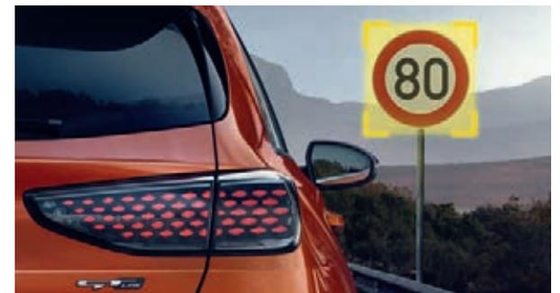
**Verkehrszeichenerkennung<sup>+</sup>.** Mithilfe der Frontkamera registriert die Verkehrszeichenerkennung für Geschwindigkeitsbegrenzungen (Intelligent Speed Limit Warning, ISLW) Schilder mit Tempolimits und Überholverbote und zeigt diese Informationen in der Instrumenteneinheit und auf dem Bildschirm des Navigationssystems<sup>+</sup> an.
