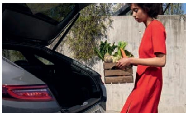
**Elektrische Heckklappe\***. Das kennst du sicher: Du willst etwas im Gepäckraum verstauen, hast aber keine Hand frei. Kein Problem: Die sensorgesteuerte elektrische Heckklappe öffnet sich automatisch, wenn der Smart-Key hinter dem Fahrzeug geortet wird.
