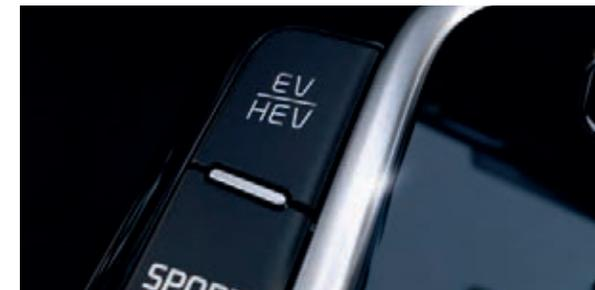
**„EV/HEV“-Taste.** Mit dieser Taste neben dem Gangwahlhebel kannst du im Kia Ceed Sportswagon Plug-in Hybrid zwischen Elektro- und Hybridantrieb (EV/HEV) wählen. Im EV-Modus<sup>2</sup> – ideal für Fahrten in der Stadt – verwendet das intelligente Antriebssystem vorwiegend elektrische Energie und reduziert damit die CO<sub>2</sub>-Emissionen gegen null. Im Hybrid-Betrieb werden je nach Fahrsituation sowohl der Benzin- als auch der Elektromotor für den Antrieb genutzt.
