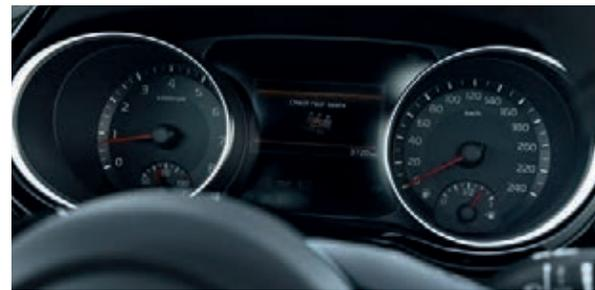
**Supervision-Instrumentenanzeige.** Das serienmäßige Kombiinstrument liefert dir auf einem hochauflösenden Display (Diagonale: 10,7 cm/4,2 Zoll) individuell einstellbare Informationen von der Außentemperatur bis zu den verschiedenen Bordcomputerdaten.
