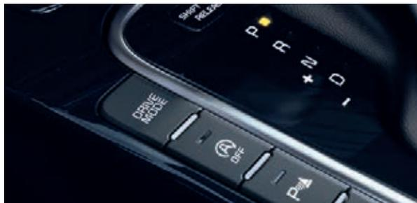
**Drive Mode Select<sup>+</sup>.** Mit dieser Fahrmoduswahl, die alle Modelle mit DCT oder Mild-Hybrid-System besitzen, kannst du deinen Fahrspaß noch steigern. Drücke einfach die „Sport“-Taste neben dem Wählhebel. Sofort wird die Gasannahme direkter, und der Motor bewegt sich häufiger im Bereich höherer Drehzahlen und damit der maximalen Leistungsabgabe. Außerdem wird durch eine veränderte Lenkunterstützung ein sportlicheres Lenkverhalten erzielt.
