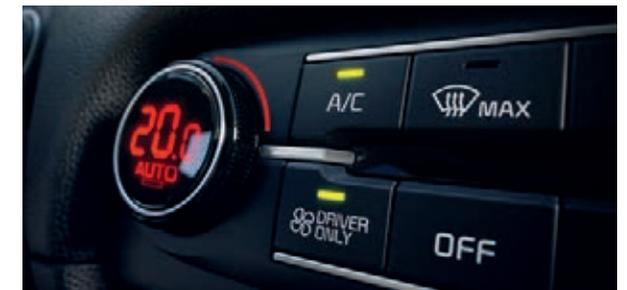
**„Driver Only“-Taste.** Der Kia Ceed Sportswagon Plug-in Hybrid verfügt über ein innovatives, energiesparendes Belüftungs- und Klimatisierungssystem. Es ermöglicht dir, bei Fahrten ohne Passagiere nur den Fahrerplatz zu klimatisieren. Dabei wird die Ventilation an den anderen Plätzen vollständig abgeschaltet – was viel Energie spart.
