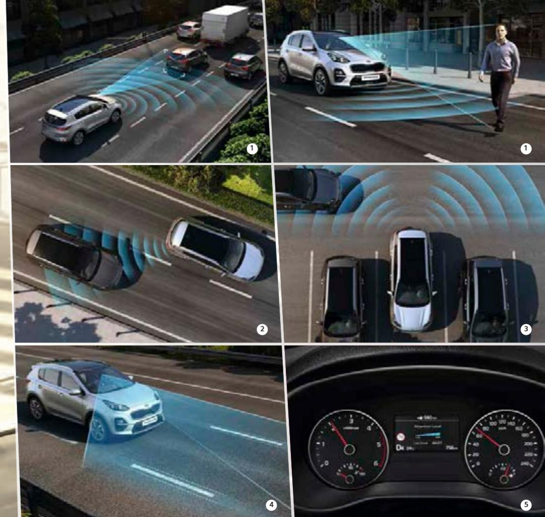
1. Der Frontkollisionwarner<sup>A</sup> (FCA)<sup>†</sup> mit autonomem Notbremsassistenten<sup>A</sup> erkennt sowohl Fahrzeuge als auch Fußgänger. Per Kamera und Radarsensoren (Nah- und Fernbereich) ermittelt das System die Entfernung und Geschwindigkeit der Objekte und warnt dich bei Gefahr einer Kollision. Erfolgt keine Reaktion, bremst der Kia Sportage automatisch, um einen Aufprall zu vermeiden oder dessen Folgen zu verringern.
