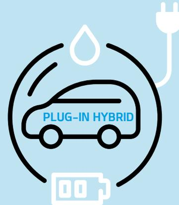
Plug-in Hybride (Englisch: Plug-in Hybrid Electric Vehicle, PHEV) haben einen mittelgroßen Akku, der mit zurückgewonnener Bremsenergie (Rekuperation) oder an der Haushaltssteckdose bzw. Ladesäule geladen wird. Kurze Strecken kann ein PHEV rein elektrisch fahren.
