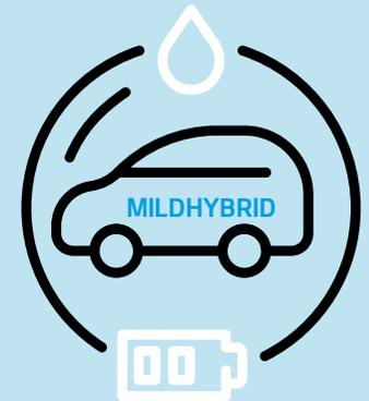
Mildhybride mobilisieren mit einem kleinen Elektromotor etwas Zusatzschub und können damit „segeln“, also rollen ohne Verbrennerantrieb. Auch beim Anfahren hilft der E-Motor. Der Akku eines Mildhybrids wird durch Rekuperation geladen.
