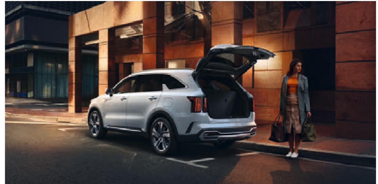
Die sensorgesteuerte elektrische Heckklappe\* macht den Zugang zum Gepäckraum besonders bequem. Ihre Öffnungshöhe lässt sich individuell einstellen: Einfach die Memory-Taste unter der Heckklappe für drei Sekunden drücken, schon ist die Position gespeichert.
