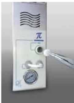
Bitte kontrollieren Sie bei jedem Filterwechsel auch das Sieb im EingangsfILTER (FEED). Sollte sich Schmutz im Sieb angesammelt haben, lässt es sich von außen ganz leicht mit einer Zange herausziehen und ausspülen.
