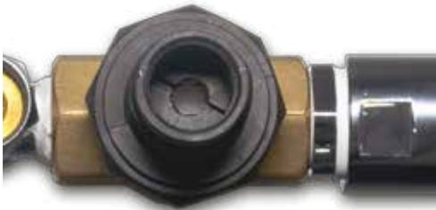
Zur Feineinstellung wird die Abdeckung auf der Unterseite gelöst und mit einem Inbusschlüssel der Größe 6 die Feineinstellung vorgenommen. Im Uhrzeigersinn erhöht sich der Druck, gegen den Uhrzeigersinn vermindert sich der Druck. Der Druckminderer darf während der Feineinstellung nicht unter Druck stehen, d.h. die Leitungswasserzufuhr muss unterbrochen sein. Arbeitsdruck soll bei 2,7-3,5 Bar liegen, Staudruck (Ruheposition) soll zwischen 3,2-3,5 Bar liegen.
