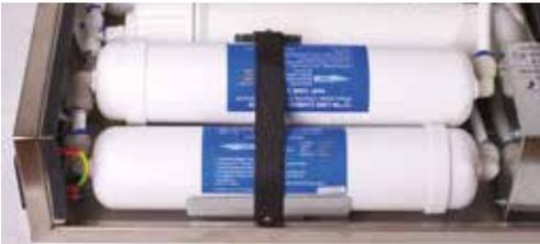
Wenn Kabelbinder: Der Verschluss kann leicht durch Wegdrücken der Arretierung geöffnet werden, ansonsten Halteband lösen.
