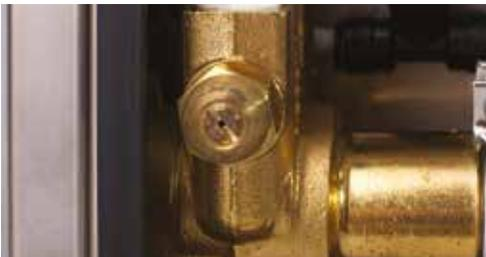
Der Arbeitsdruck der Pumpe kann mittels der Einstellschraube verändert werden. (Im Uhrzeigersinn wird der Druck erhöht.)
