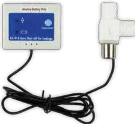
Der Feuchtigkeitssensor des **Water Stops** wird neben Umkehrosmose und PI®-Cell Vitalizer gelegt. Sobald der Sensor mit Wasser in Berührung kommt, schaltet der Water Stop die weitere Wasserzufuhr ab. Gleichzeitig ertönt ein akustisches Alarmsignal. Bitte die Batterie wechseln, sobald ein akustisches Alarmsignal ertönt und ein rotes Licht blinkt.
