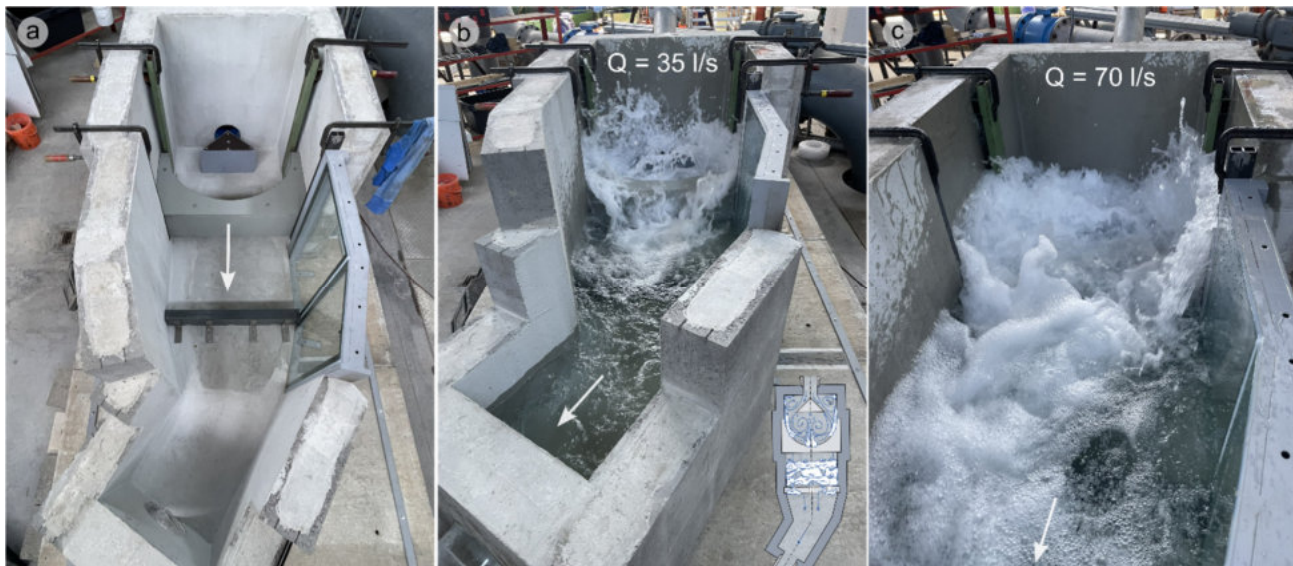
Abbildung 28: Erste Tests am Gegenstromtosbecken im Wasserbaulichen Forschungslabor; aufgrund der Geländegeometrie liegt in der ursprünglichen Planung ein Knick am Ende des Bauwerks vor.
