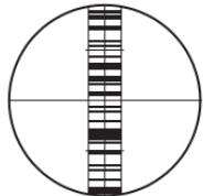
👉 精确测量时，一般要瞄准标尺中间并且物镜调焦到标尺最清晰为止。
