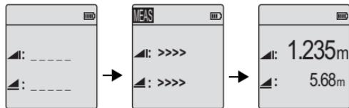
Ölçüm Bekleme Modu      Ölçüm yapılıyor      Yükseklik ve mesafe ile ölçüm
