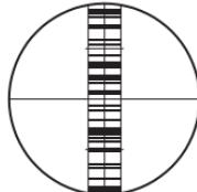
👉 正確な測定のためには、必ず、バーコード標尺の中心をねらい、標尺に焦点を合わせます。
