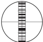
👉 Pro přesné měření vždy zacílte doprostřed latě s čárovým kódem a zaostřete na obrázek latě.
