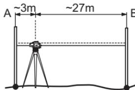
**第三步:** 瞄准标尺 B 按测量键。测量结果显示在显示屏上，按键 3 秒钟接受测量结果。
