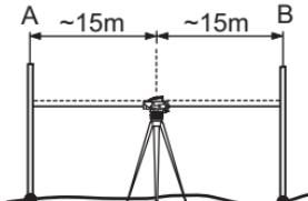
**第一步:** 瞄准标尺 A 按测量键。测量结果显示在显示屏上，按键 3 秒钟接受测量结果。
