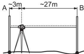
ステップ 3: 標尺 B に照準を合わせ、測定キーを押します。測定表示を承認するには、測定キーを3秒間押してください。
