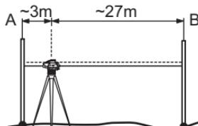
**Krok 3:** Zaostřete na La' B a stiskněte tlačítko MĚŘENÍ. Displej měření, pro přijetí stiskněte a držte 3 sekundy tlačítka měření.
