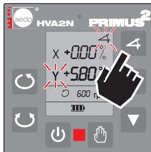
Taste **4** 2 x drücken: im Display erscheint die Neigung der Y-Achse wie zuvor mit AUTOALIGN single ermittelt (5,80%)
