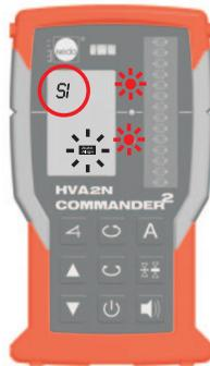
LEDs und das Symbol AUTOALIGN blinken während des Suchvorgangs. Im Display des COMMANDER 2 HVA2N erscheint ein >> SI <<
