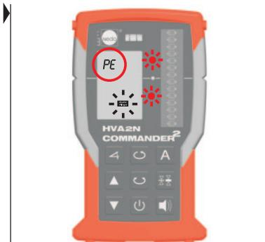
LEDs und das Symbol AUTOALIGN blinken während des Suchvorgangs. Im Display des COMMANDER 2 HVA2N erscheint ein >> PE<<.
