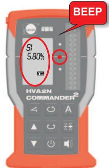
Der Suchvorgang wird beendet, wenn der Laserstrahl die Nullmarke des Empfängers getroffen hat. Die beiden blinkenden LED erlischen, das Symbol AUTOALIGN leuchtet dauerhaft. Der COMMANDER 2 HVA2N erzeugt einen Piepton und zeigt die ermittelte Neigung in %-Werten an
