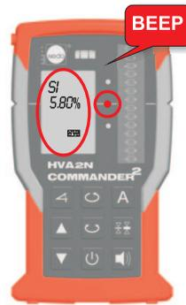
Nach Abschluß von AUTOALIGN single wird die Neigung der Y-Achse im Display angezeigt (hier: 5,80%)
