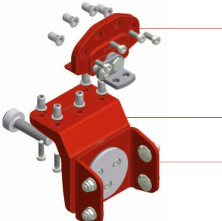
Lackierte Teile sind zur Verdeutlichung rot dargestellt. Schrauben und Splinte werden nicht lackiert.
