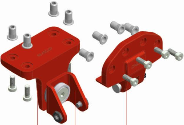
Lackierte Teile sind zur Verdeutlichung rot dargestellt. Schrauben und Splinte werden nicht lackiert.
