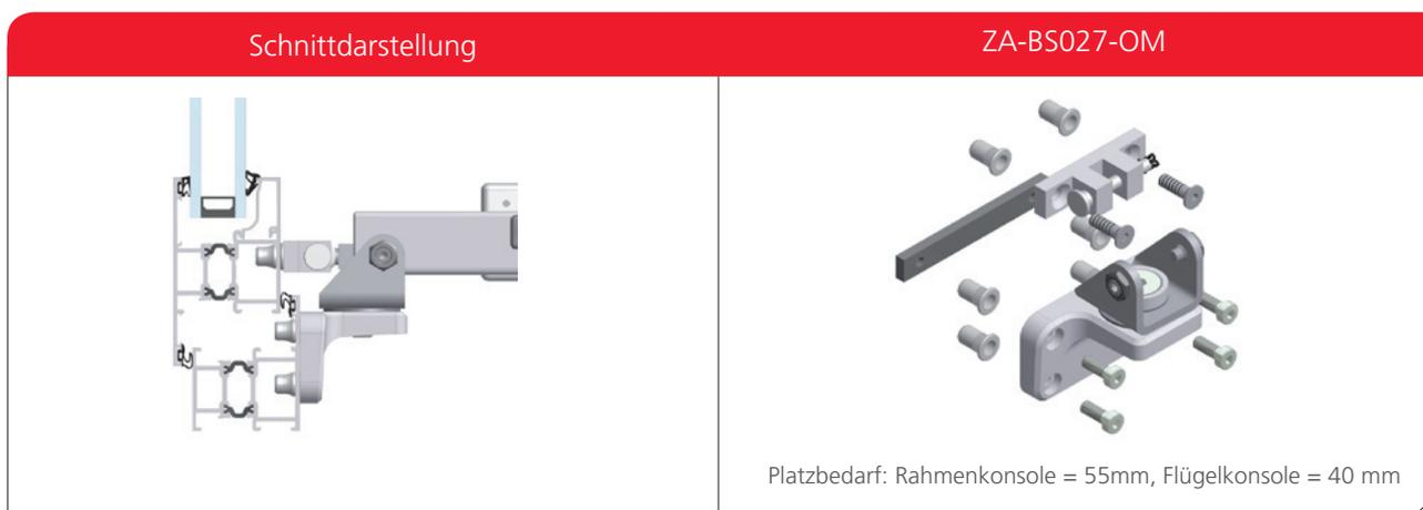
Die dargestellte Antriebskonsole ist geeignet zur Verwendung an Kipp- und Klappflügeln.
