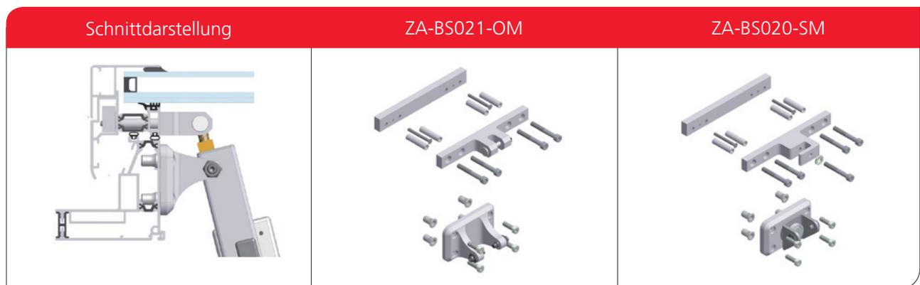
Die dargestellten Antriebskonsolen sind geeignet zur Verwendung an Kipp- und Klappflügeln.
