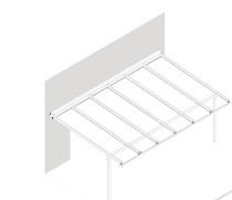
Ü1 Sparrenüberstand, außen Ü1s wie Ü1, mit Stahlverstärkung
