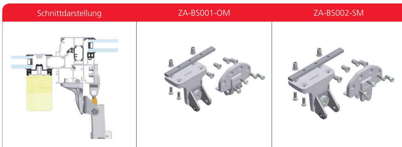
Die dargestellten Antriebskonsolen sind geeignet zur Verwendung an Kipp- und Klappflügeln.
