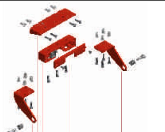
Lackierte Teile sind zur Verdeutlichung rot dargestellt. Schrauben und Splinte werden nicht lackiert.
