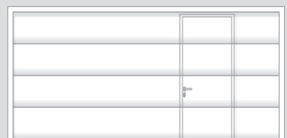
Asymmetrische Anordnung bei Torbreite über 3,50 m – wahlweise links oder rechts
