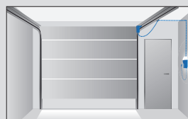
Bei verbautem Seitenschlag, z. B. durch eine Nebentür, kann eine Kabelverlängerung eingesetzt werden.
